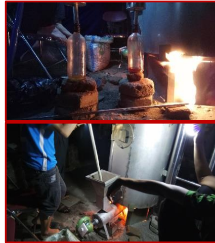
Gambar 6. Pengujian alat pirolisis dan burner.
