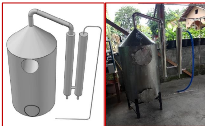
Gambar 5. Hasil perancangan dan fabrikasi alat pirolisis.
