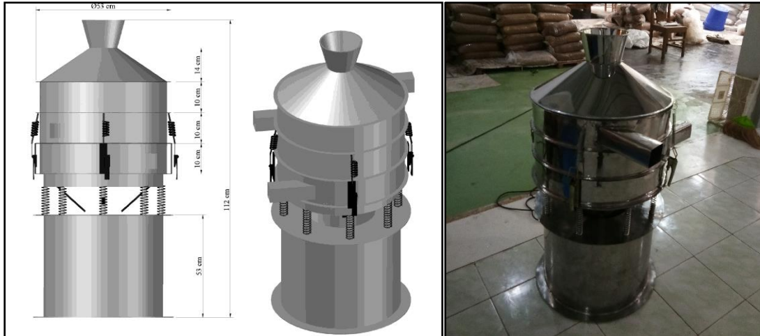
Gambar 7. Hasil rancangan dan fabrikasi mesin ayakan gula semut
