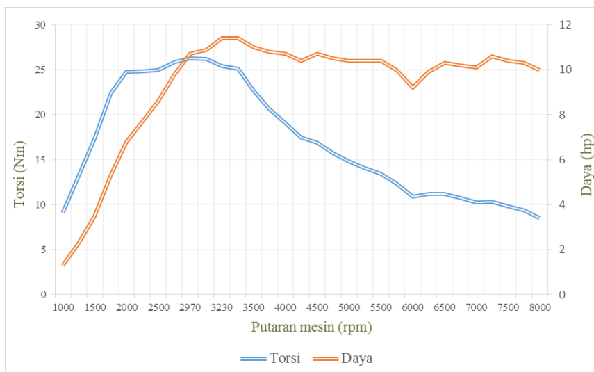
Gambar 3. Grafik torsi dan daya kampas kopling sayatan lubang dan pelubangan pada rumah kopling
