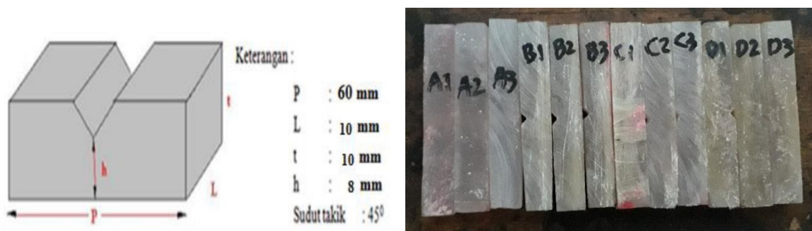
Gambar 2. Spesimen Uji Impak
