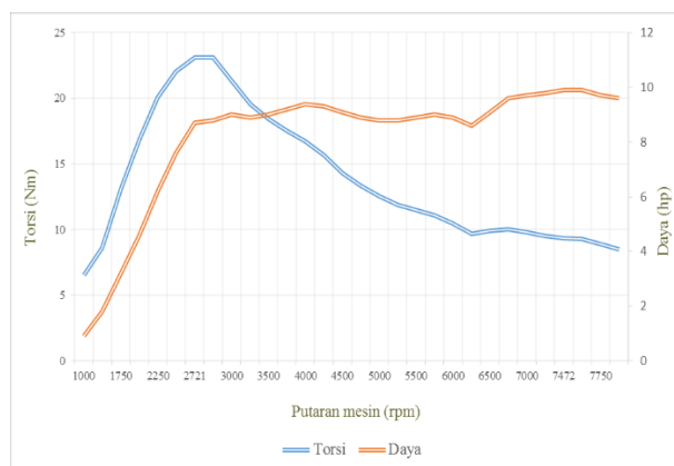
Gambar 2. Pengujian Torsi dan Daya Pada Kopling Standar
