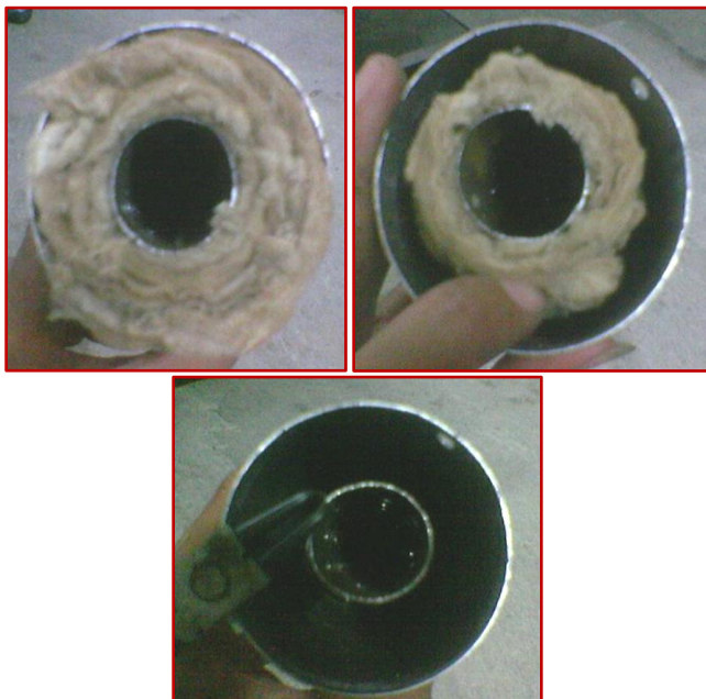
Gambar 2. Susunan glasswool penuh, setengah penuh, dan tanpa glasswool.
