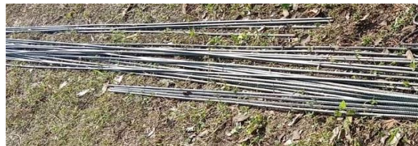
Gambar 2. Tulangan polos (sumber gambar: obyek penelitian)
