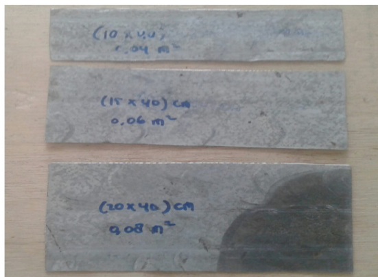
Bentuk sudu datar dengan luas 0.04 m 2 , 0.06 m 2 dan 0.08 m 2
