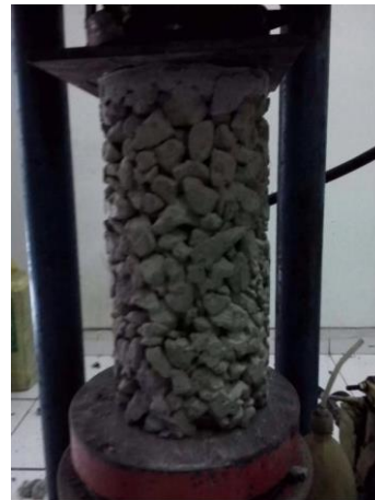
Gambar 4. Pengujian kuat tekan
