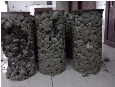
Gambar 14. Kerusakan benda uji kuat tekan (rasio 3,5 dan fas 0,30)
