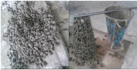
Gambar 8. Rasio agregat semen 5, fas 0,25
