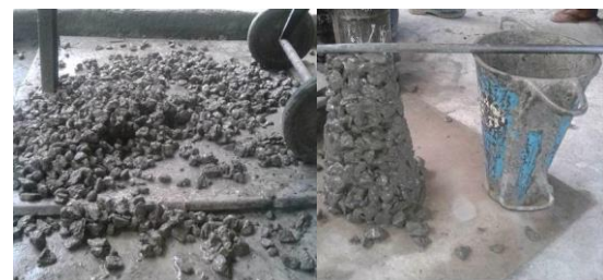
Gambar 7. Rasio agregat semen 3,5, fas 0,25
