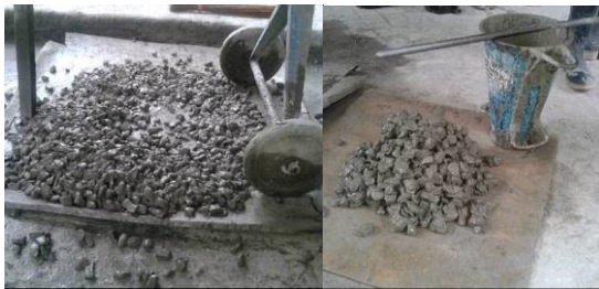
Gambar 9. Rasio agregat semen 3,5, fas 0,3
