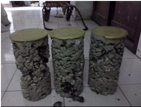
Gambar 12. Kerusakan benda uji kuat tekan (rasio 3,5 dan fas 0,25)
