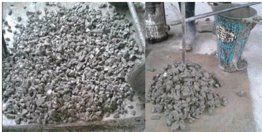
Gambar 10. Rasio agregat semen 5, fas 0,3
