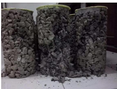
Gambar 15. Kerusakan benda uji kuat tekan (rasio 5 dan fas 0,30)
