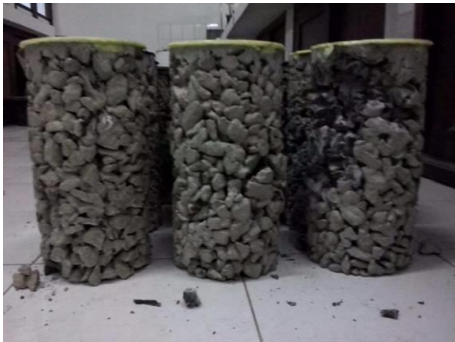
Gambar 13. Kerusakan benda uji kuat tekan (rasio 5 dan fas 0,25)
