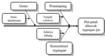
Gambar 1. Analisis kemungkinan terjadinya patah pada plat aluminium sebelum tegangan ijin tercapai
