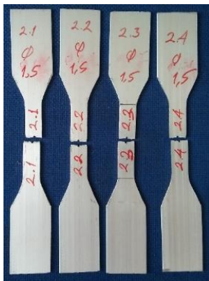
Gambar 6. Pola kerusakan benda uji berlubang
