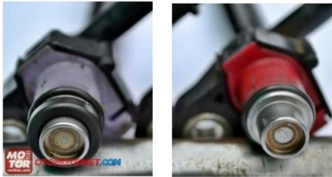
Gambar 1. Injektor standar (kiri) dan injektor racing (kanan)
