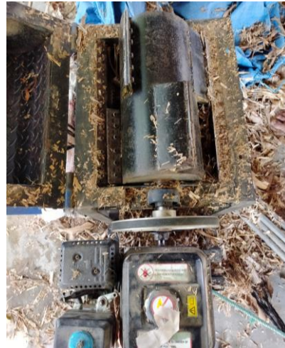
Gambar 7. Konstruksi bag. dalam pisau penghancur/pencacah yg hasilnya sudah sesuai dg harapan
