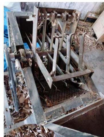
Gambar 2. Konstruksi bagian dalam perajang dengan desain pisau yang kurang tepat.
