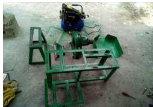
Gambar 5. Komponen mesin penghancur pakan ternak
