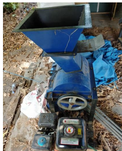
Gambar 8. Hasil evaluasi dan perancangan ulang mesin penghancur/pencacah bahan pakan ternak yang sudah bisa dimanfaatkan dan diuji keandalannya.
